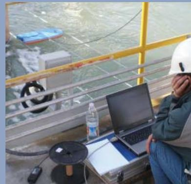
**Intervenciones en los elementos del fondeo del correntómetro y del turbidímetro localizado en la bocana del Port Olímpic de Barcelona, para el Instituto de Ciencias del Mar.**
